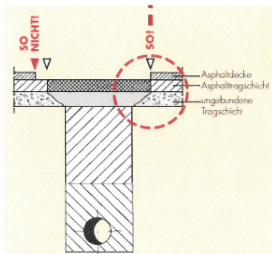
Die Asphalttschichten sind nach dem Einbau der Tragschichten ohne Bindemittel um das Maß der Auflockerung der Randzonen der Tragschichten ohne Bindemittel zurückzunehmen.
